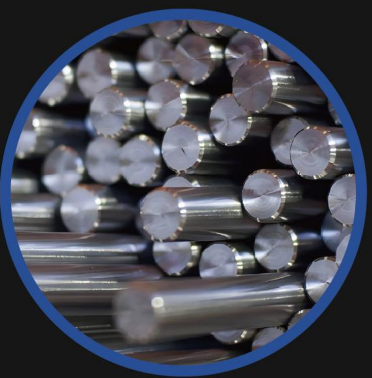
高强度植体材料 冷作钛工艺,材料强度较常规种植体提升约30%,长期稳定
